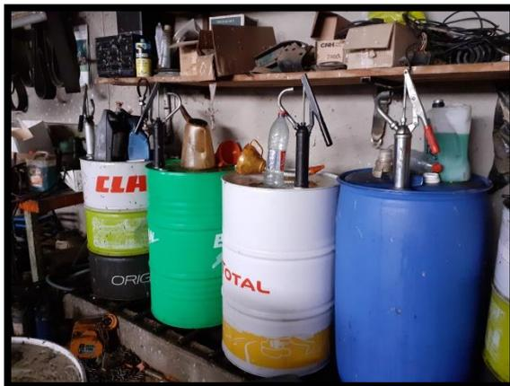
**Figure 2 :** Stockage sur bac de rétention
